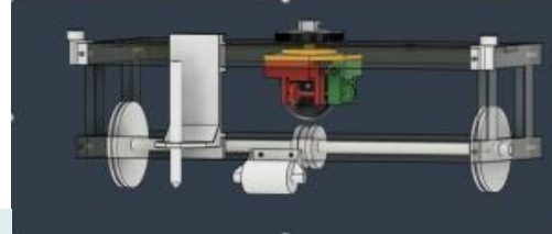
Analyseur harmonique Coradi à trois intégrateurs de base 360 mm. ©Lebée - Inventaire général /École polytechnique
